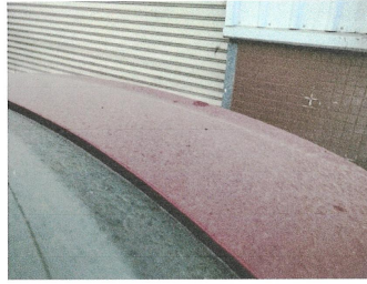
↑ 行李箱盖/后盖: 修复痕迹明显
