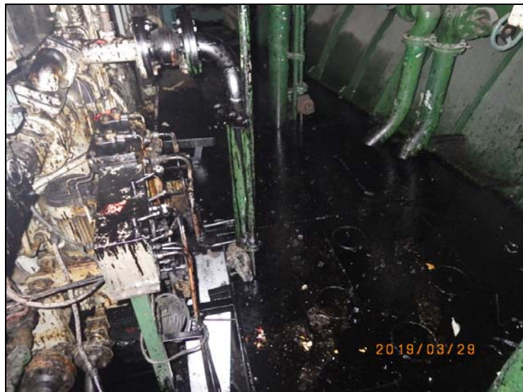
24. 机舱底层,表面出现大范围油污
